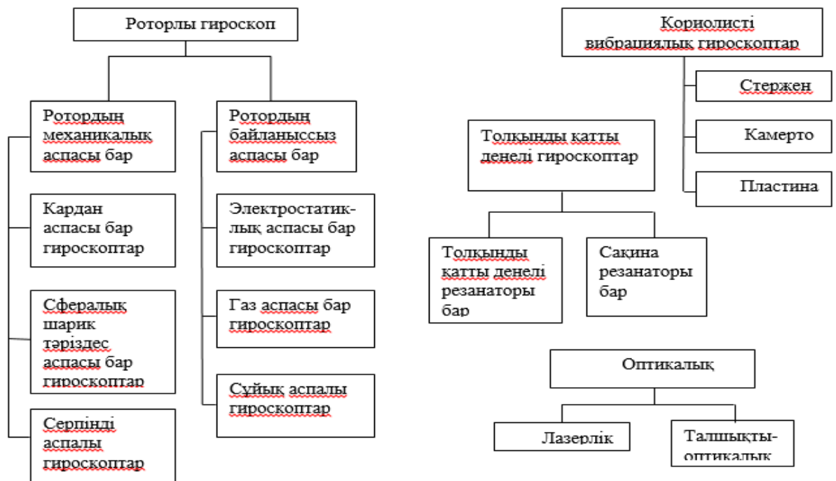
1.15 Сурет - Гироскоптардың негізгі типтері
